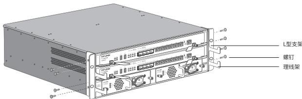
图2-1 理线架和L型支架安装示意图
