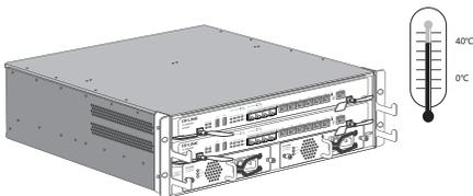
为保证路由器长期稳定工作，延长使用寿命，请维持环境一定的温度和湿度。过高或过低的环境湿度易引起绝缘材料漏电、变形甚至金属部件锈蚀现象，温度过高会加速绝缘材料的老化过程，严重影响设备使用寿命。该系列路由器的正常工作和存储温度/湿度如下表2-1。
